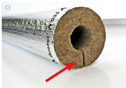
Zur Minimierung des Wärmeverlustes bei waagrechter Montage die Längsnäht so ausrichten, dass sich diese unten am Rohr befindet! <sup>1)</sup>
